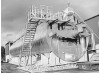
Reaktionsbehälter für die Vergärung von Grünabfällen, wie er im Konzept 2010 für die KBA Hard vorgesehen ist
