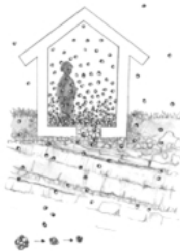
Radon kann durch das Erdreich ins Haus steigen .....
